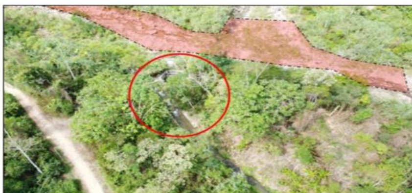
FIGURA N° 02: TRAMO CRITICO EN EL RIO PACOTE (RIO PACOTA), DONDE EN TIEMPOS DE MAXIMAS AVENIDAS SE VE AFECTADA LA INFRAESTRUCTURA DE LA BOCATOMA PACOTA
